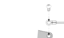
Рисунок 4.4 – Соединение клеммы заземления прибора с клеммой заземления пользовательского провода
